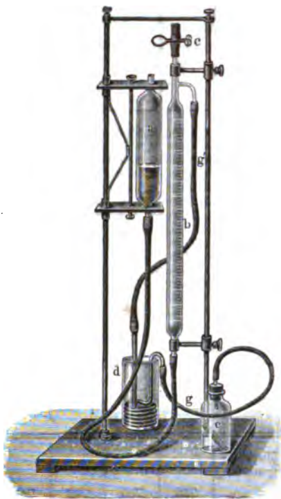
Fig. 2. — Appareil Dietrich-Frühling pour le dosage de l'acide carbonique.
